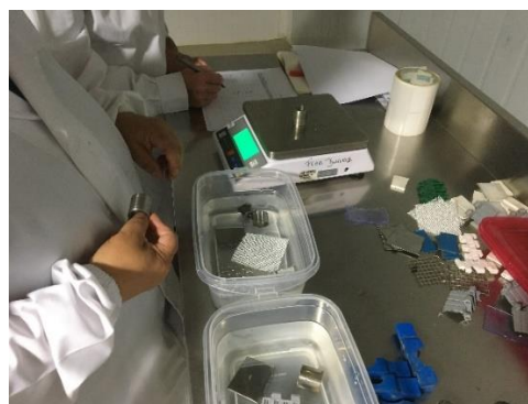
Figura 22. Pesaje e inmersión de los materiales
